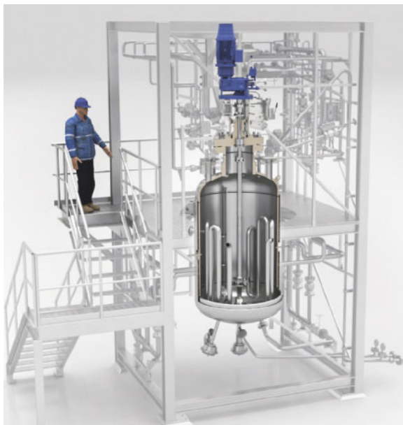
Hydrierreaktormodul in Rahmenbauweise
